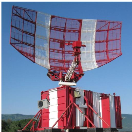
Аэродромный обзорный радиолокатор АОРЛ-1АМ ЕЛ1.231.020-22 (в исполнениях) с вторичным каналом режима "RBS" используется в качестве источника радиолокационной информации о воздушной обстановке в зоне аэропортов для существующих и перспективных систем УВД и районных центров АС УВД.
